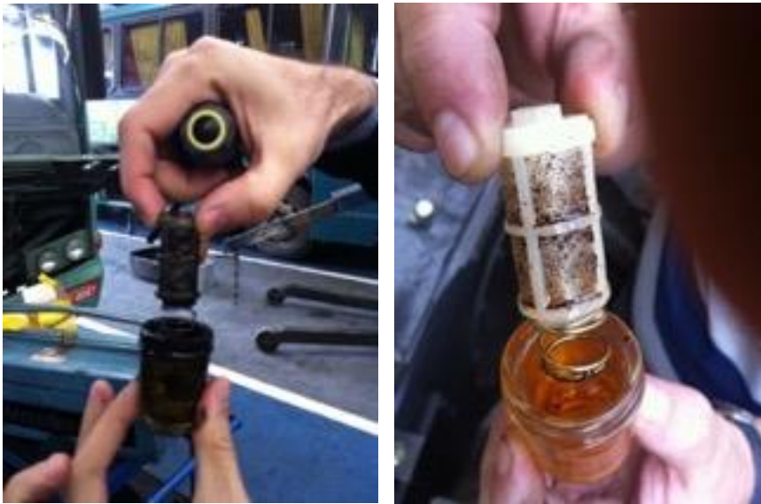
Figura 18. Filtro cesto com Diesel Oxidado e presença de borra.
