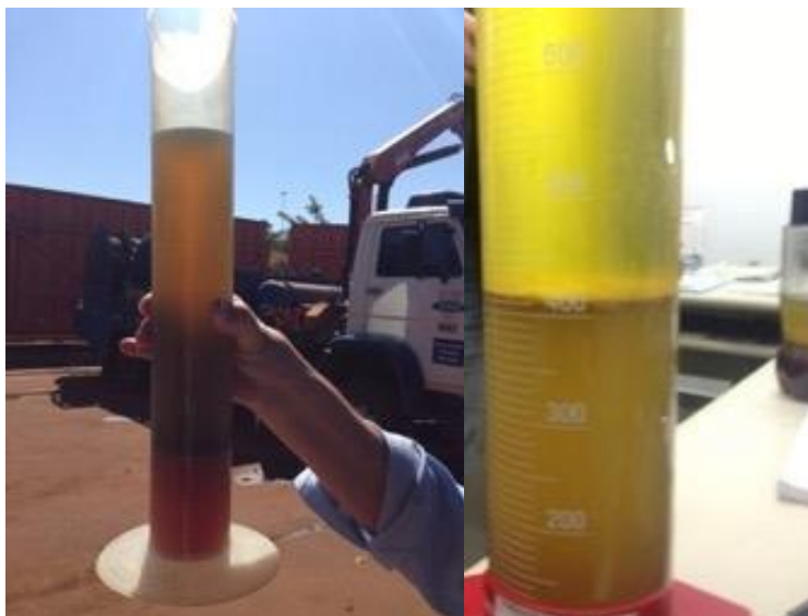
Figura 16. Aspecto de óleo diesel extraído de filtro de caminhão em setor sucroalcooleiro, presença de água livre e biomassa na interface óleo-água.
