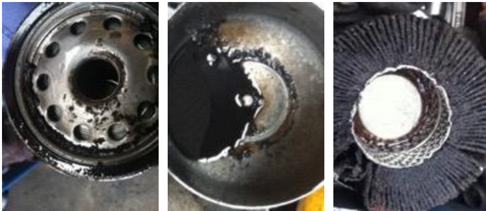
Figura 14. Filtro de ônibus saturado - Oxidação e Sedimentos.
