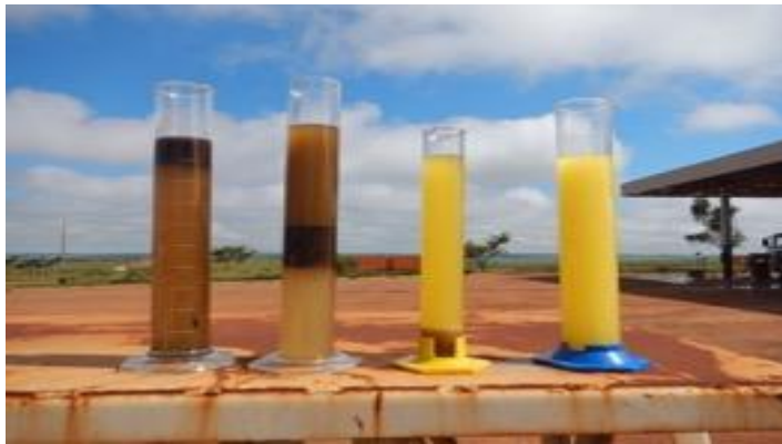
Figura 20. Aspecto de amostras óleo diesel coletadas em tanques que não são drenados corretamente.
