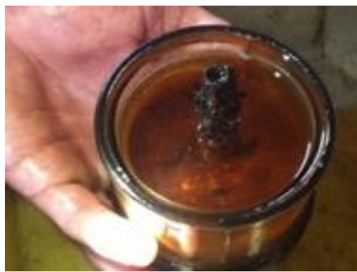
Figura 12. Filtro separador de trator com água e sedimento de origem microbiana.
