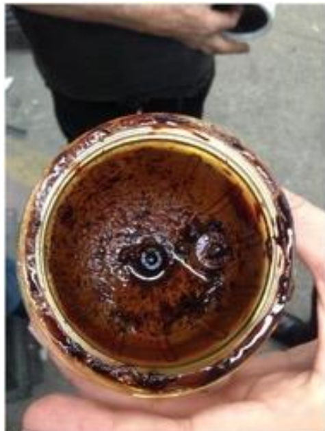
Figura 10. Depósito de sedimentos no fundo de um filtro separador.
