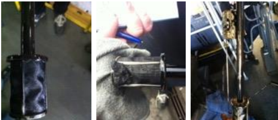
Figura 15. Pescador de ônibus com processo de oxidação e formação de borra.
