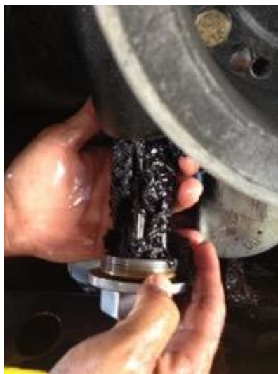
Figura 19. Filtro cesto de bomba de combustível de posto com formação de borras.
