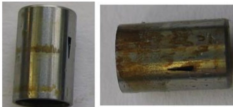
Figura 4 Formação de depósitos biológicos e de produtos de envelhecimento de biodiesel dando aspecto “envernizado” ao componente de aço
