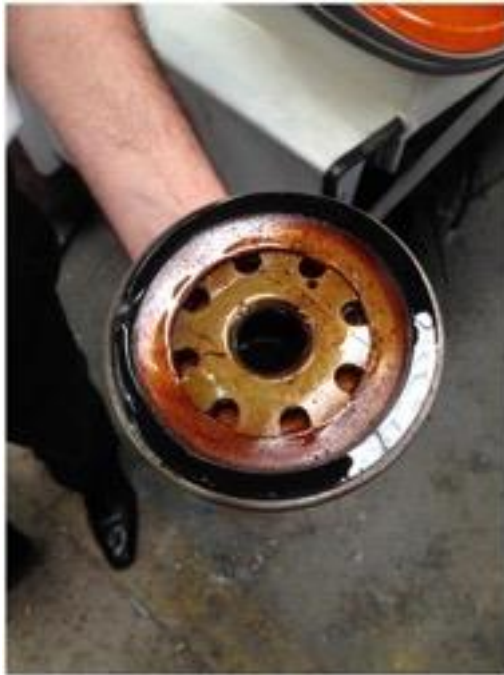
Figura 9. Filtro com formação de “verniz” por depósito e degradação do combustível.
